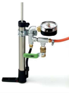
開放弁を閉じた状態 (シリンダ内部圧力が上がる)
