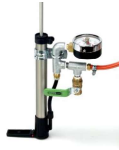
開放弁を閉じた状態 (シリンダ内部圧力が上がる)
