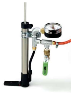
開放弁を開いた状態 (シリンダ内部圧力が上がらない)
