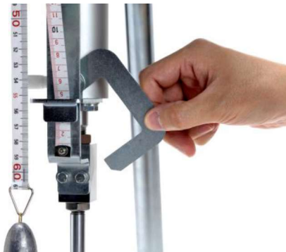
落下防止ストッパーを手で回転させ、ガイドロッドに引っ掛ける。
