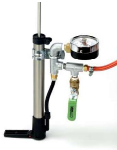
開放弁を開いた状態 (シリンダ内部圧力が上がらない)
