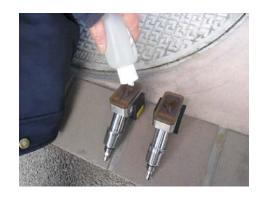
7.4 トランスデューサー接続ケーブルを取り付けます。 一番右側のコネクターに上流のケーブル(赤色)を差し込み① 左側のコネクターに下流のケーブル(青色)を差し込みます。②
