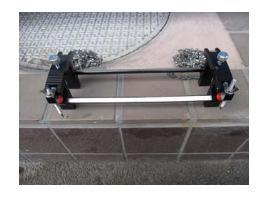
7.1 6で算出された設置間距離の長さに設定します。 今回は94.33mmに長さをあわせます。
