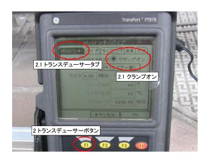
2.2 付属のトランスデューサー番号を選択します。(例では#402シェアー波) 2.3 ウェッジ温度(配管表面温度)を入力します。
