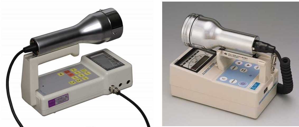
図 1-8 GM サーベイメータの例
