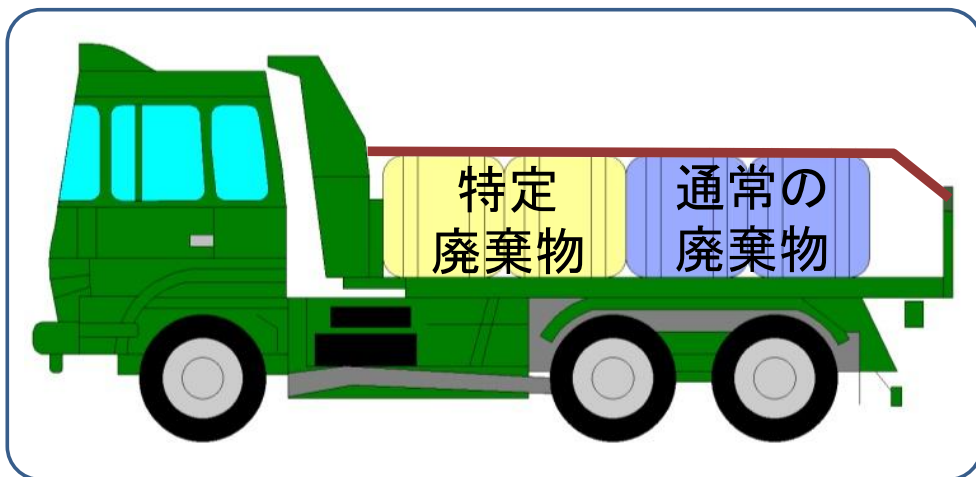
容器により区分して運搬する例（フレキシブルコンテナ）
